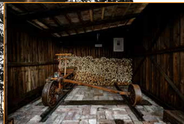
Az egyik legkülönlegesebb darab ez a több mint 100 éves, fából készült, eredeti hajtány. Ilyen típusú hajtányok később fémmel készültek és csővázak voltak.
