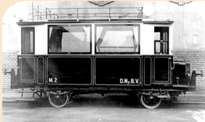
A MÁVAG fővállalkozású, német gépi berendezésű, Ganz járműszerkezetű M.2 pályaszámú DNyBV-sínautóbusz (MMKM)
