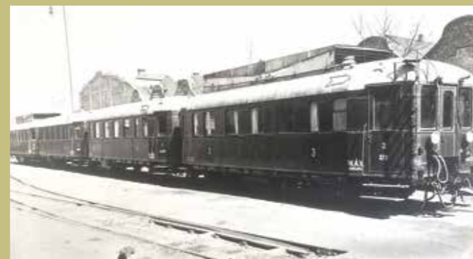
Kiszállításra váró, elektro-pneumatikus távvezérlésű, két motor- és két közbezárt pótkocsiból álló vonat a gyár területén
