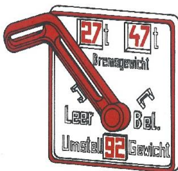
4. ábra. Raksúlyváltó karjában hosszúkás nyílással
